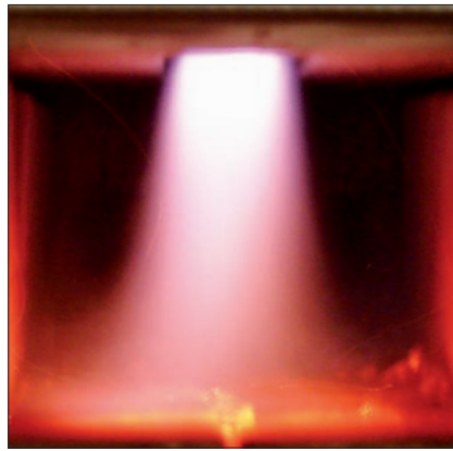
Vollständige Verbrennung der Holzgase in der unteren Brennkammer
